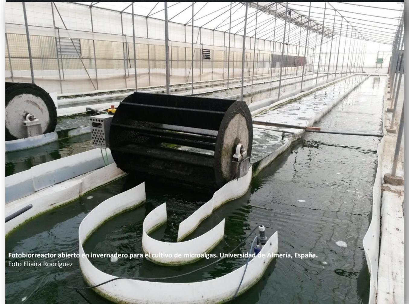
Fotobiorreactor abierto en invernadero para el cultivo de microalgas. Universidad de Almería, España.
